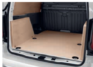
BODEN MIT WANDVERKLEIDUNG IN ZWEI AUSFÜHRUNGEN 1. Holzverbundplatte, lackiert 2. Kunststoff, Polypropylen
