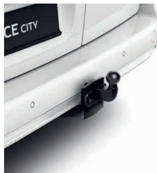
ANHÄNGEZUG-VORRICHTUNG Zur geflanschten Anhängzugvorrichtung wird auch ein 13-poliger Elektrosatz angeboten.
