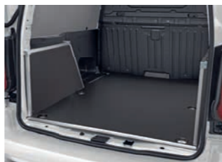
BODEN MIT WANDVERKLEIDUNG IN ZWEI AUSFÜHRUNGEN 1. Holzverbundplatte, lackiert 2. Kunststoff, Polypropylen
